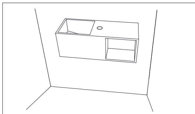
Bepaal de gewenste hoogte. Zet de bak tegen de muur. Gebruik een waterpas om ervoor te zorgen dat beide zijden waterpas zijn. Markeer locatie en boor de gaten in de muur.
