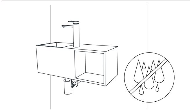
Sluit alle toevoerslangen aan op de kraan. Open de hoofdkraan en controleer op lekkages.
