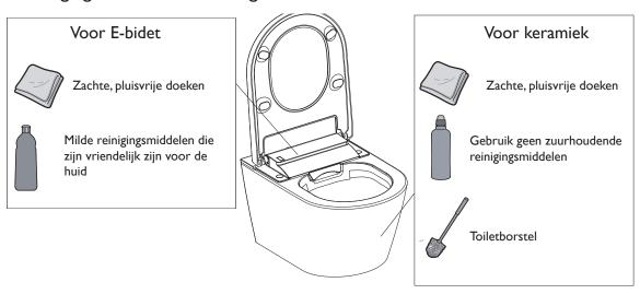
Gebruik geen reinigingsmiddelen met sterke zuren en basen. Gebruik geen harde borstel om het E-bidet te reinigen.
